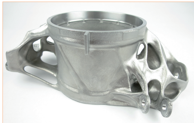
Bild: Bionisch optimierter Radträger eines Formel-Rennwagens (© Netzwerk Strahlschmelzen)
